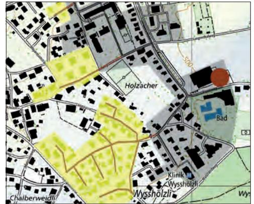
Wärmeverbund Buchsi Ost mit dem Standort der Zentrale (Kreis), dem bereits mit Fernwärme erschlossenen Gebiet (grau schattiert) und den nächsten Erweiterungsstapfen (gelb). (Bild: ewk)
