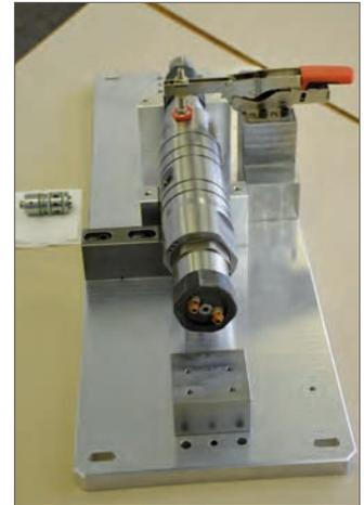
Der bei DUAP neu entwickelte DUAGAS- & Wasserstoff-DI-Injektor.
